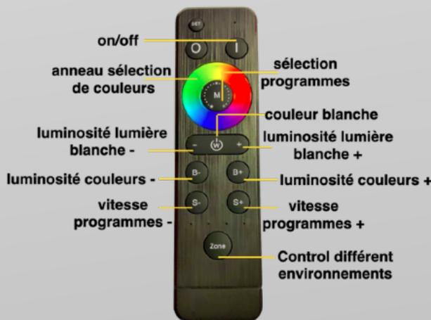
**FONCTIONS DE LA TÉLÉCOMMANDE RADIOFRÉQUENCE**
